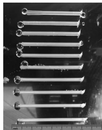
(a) 打印完成的同轴硅橡胶管道
